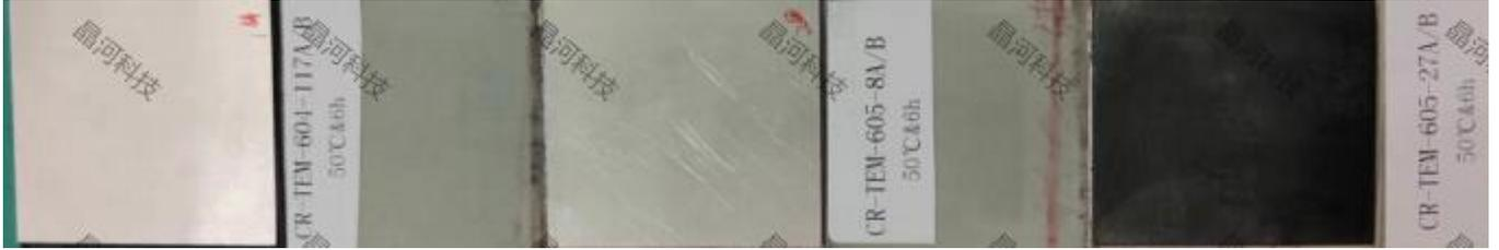
图 2.8-11 涂刷不锈钢片与靶材料之间 50°C&6h 体积电阻测试样品
