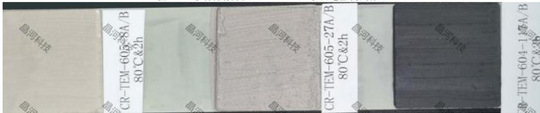
图 2.8-6 涂刷靶材片上 80°C&2h 表面电阻测试样品
