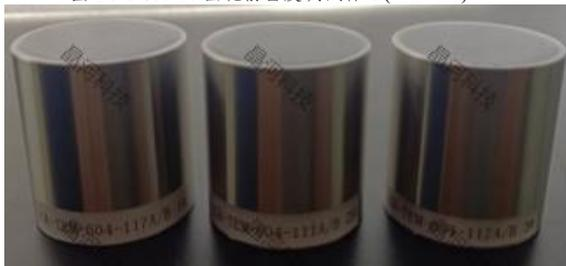
图 2.3-5 604-117 固化前密度测试样品(A:B=1:1)
