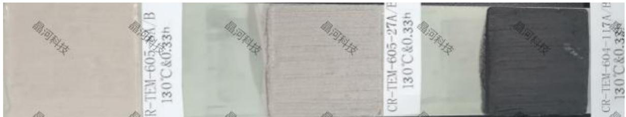
图 2.8-5 涂刷靶材片上 130°C&0.33h 表面电阻测试样品
