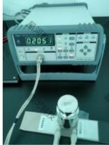
图 2.8-23 涂刷靶材片 605-27 电阻测试
