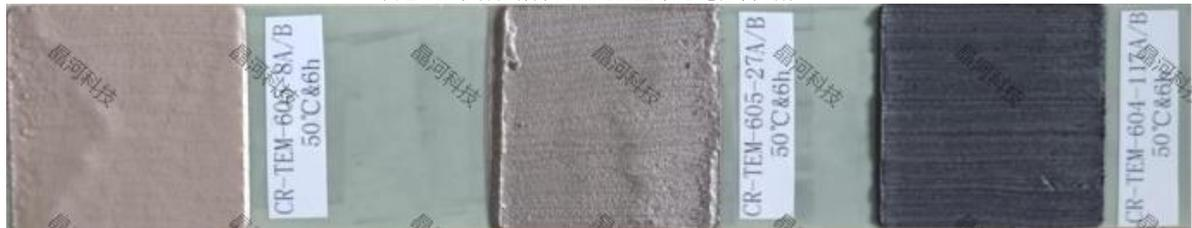
图 2.8-7 涂刷靶材片上 50°C&6h 表面电阻测试样品
