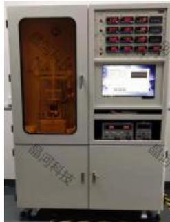
图 2.4-4 L9389 导热系数测试仪
