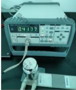
图 2.8-22 涂刷靶材片 605-8 电阻测试
