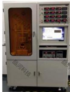
图 2.5-4 L9389 导热系数测试仪
