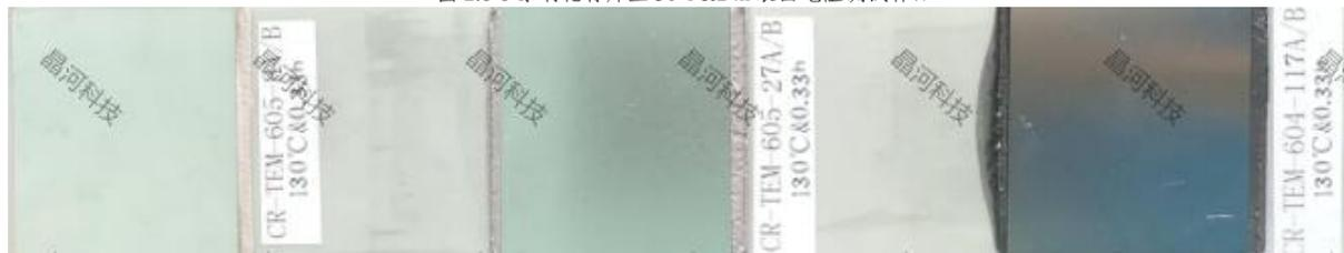
图 2.8-9 涂刷不锈钢片与靶材片之间 130°C&0.33h 体积电阻测试样品
