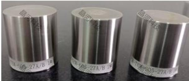
图 2.3-3 605-27 固化前密度测试样品(A:B=1:1)
