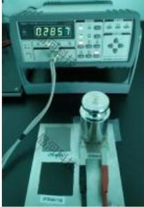
图 2.8-19 涂刷不锈钢片 605-8 电阻测试
