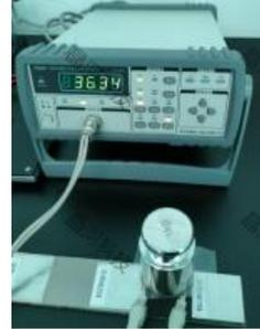
图 2.8-24 涂刷靶材片 604-117 电阻测试
