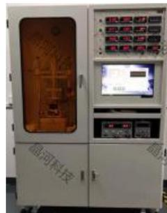
图 2.5-5 L9389 导热系数测试仪
