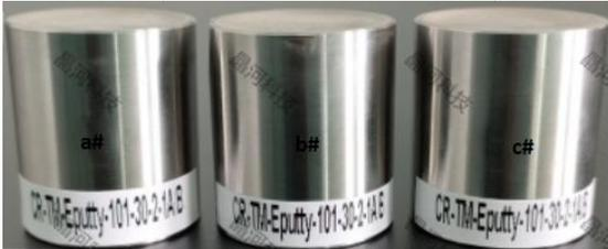
图 2.3-1 101-30-2-1A/B 固化前密度测试样品(10:1)
