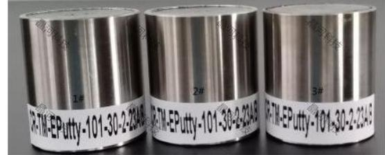
图 2.7-2 101-30-2-23A/B (10:1) 固含量测试样品
