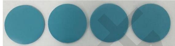
图 2.4-2 TC-4525 (A:B=1:1) 硬度/固化后密度测试片
