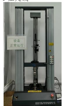
图 2.5-9 万能材料试验机
