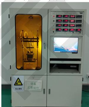
图 2.7-8 L9389 导热系数测试仪
