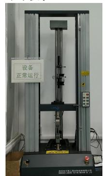
图 2.6-9 万能材料试验机
