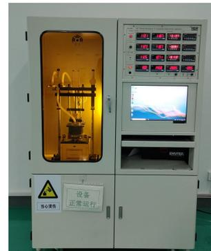
图 2.8-7 L9389 导热系数测试仪
