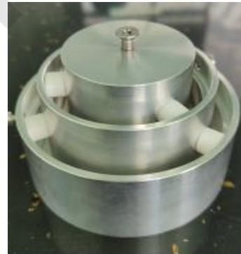
图 2.10-4 液体测试电极
