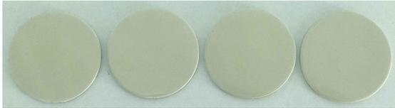
图 2.4-1 CR TM-4525T (A:B=1:1) 硬度/密度测试片
