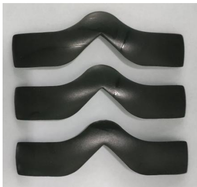
图 2.6-1 CR EM-SPA-1212-8 (A:B=1:1) 撕裂强度 C 型样品
