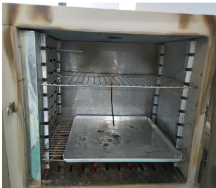
图 2.2-5 裸露电线浸入状态
